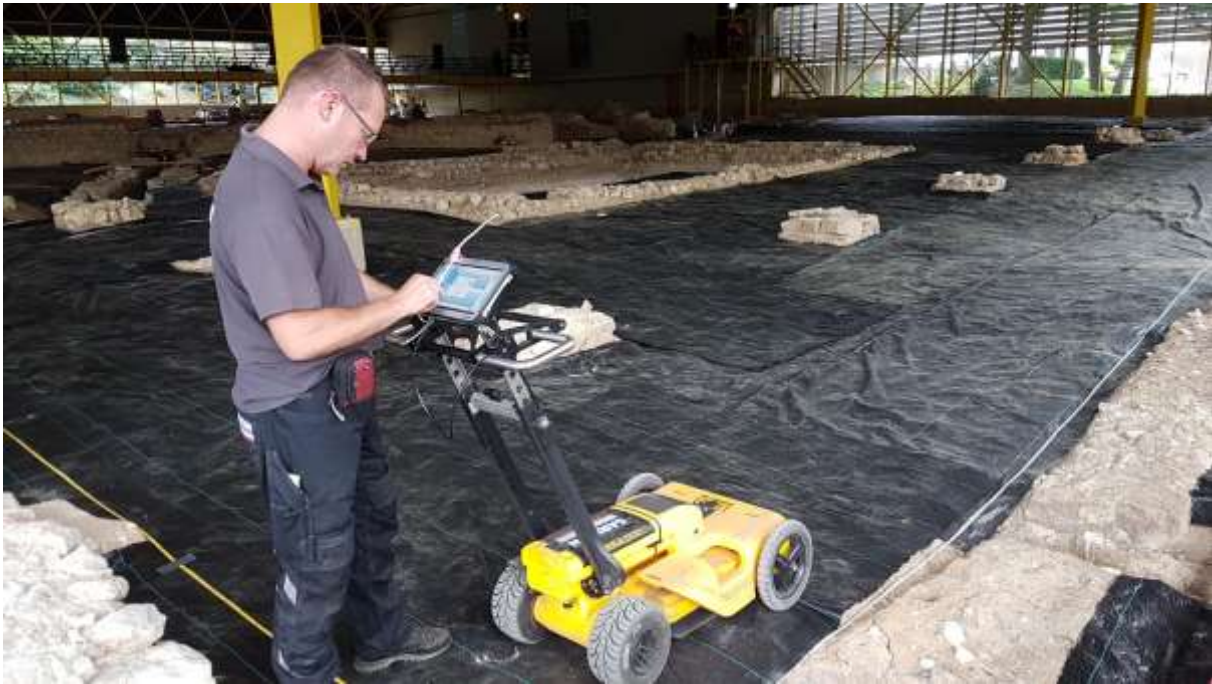
Figuur 4: Grondradaronderzoek in het badhuis van de thermen
